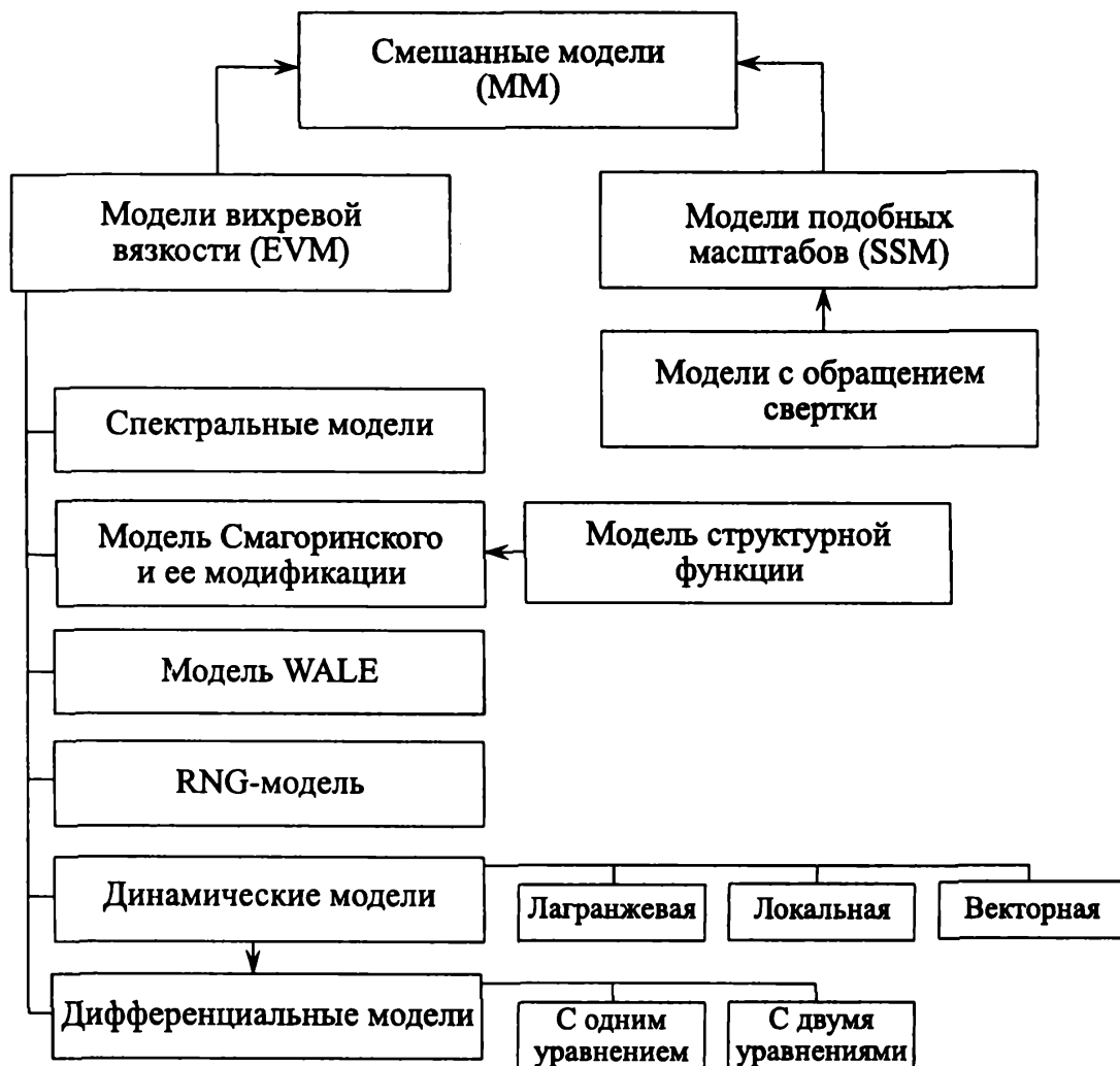
Рис. 3.1. Классификация подсеточных моделей
