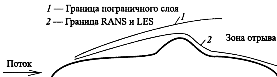
Рис. 1.12. Течение в пограничном слое с локальным искривлением поверхности
